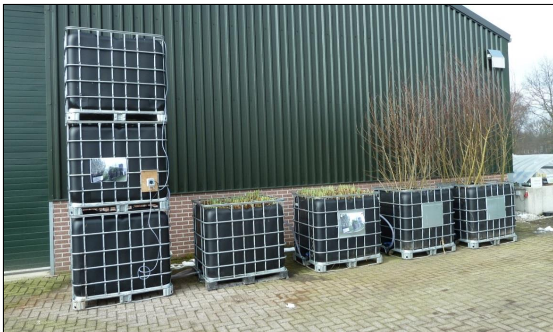
Rys. 42. Stanowisko bioremediacyjne BIOFILTER i boczne kontenery z roślinami fitoakumulacyjnymi
