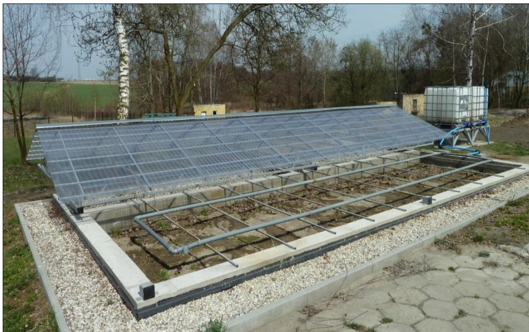
Rys. 28. Stanowisko bioremediacyjne PHYTOBAC z odsuwającym dachem
