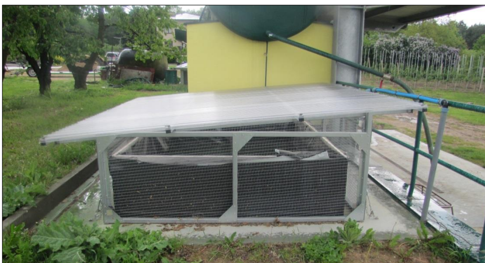
Rys. 54. HELIOSEC – stanowisko dehydratacyjne o pojemności zbiornika 2500 l
