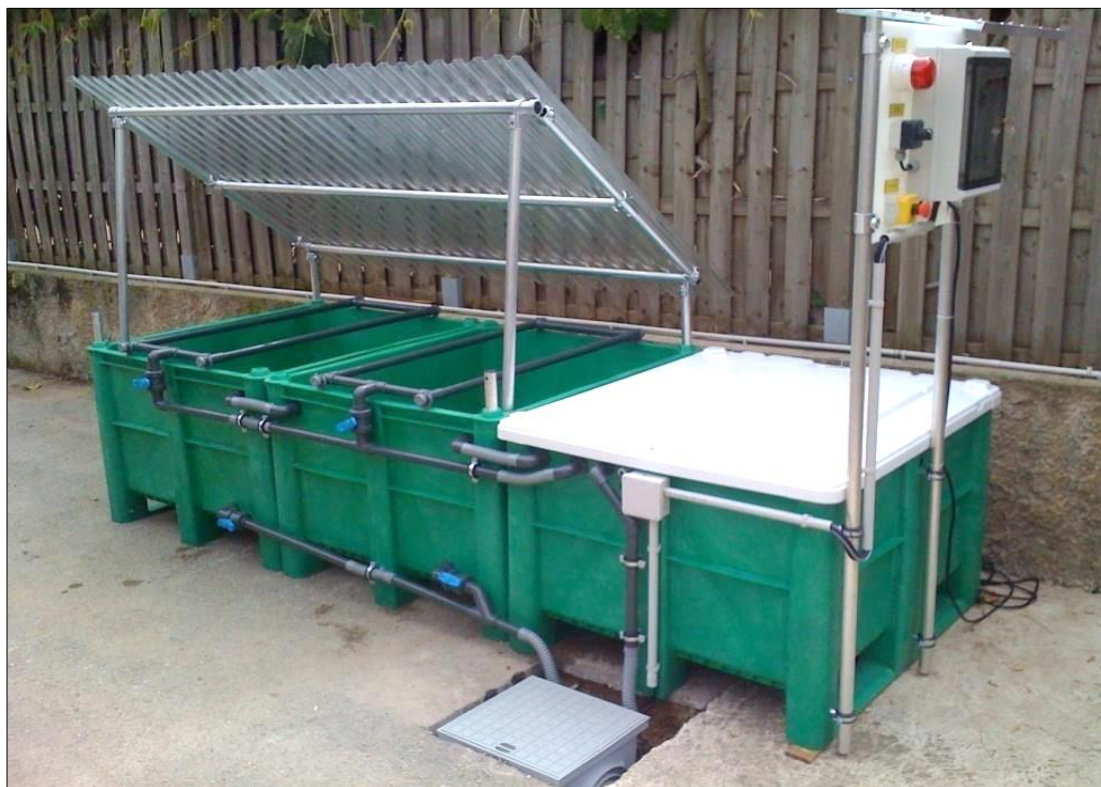
Rys. 32. Modułowe stanowisko bioremediacyjne PHYTOBAC
