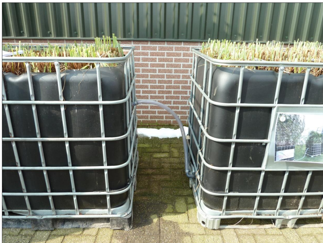
Rys. 44. Odbiór odcieków z bocznych kontenerów stanowiska BIOFILTER
