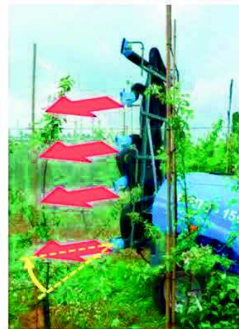
Opryskiwacz z indywidualnymi wylotami powietrza
