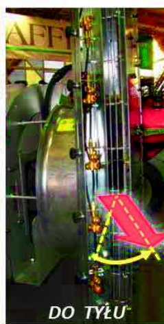
Opryskiwacz deflektorowy z ustawną szczeliną powietrza
