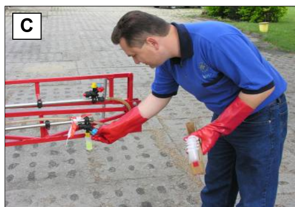
Rys. 49 Eksperyment dotyczący jednokrotnego i wielokrotnego mycia opryskiwacza z wykorzystaniem zabarwionej cieczy: A – wypryskiwanie popłuczyn podczas jazdy opryskiwacza; B - kolejny cykl płukania instalacji z poborem odpowiedniej porcji wody z dodatkowego zbiornika; C – pobieranie próbek cieczy z rozpylaczy po każdym cyklu płukania instalacji.
