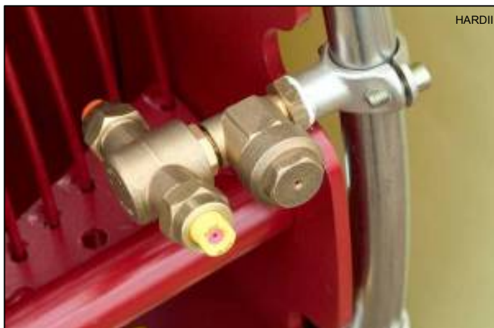
Rys. 44 Podwójne, obrotowe korpusy umożliwiają szybka zmianę rozpylaczy
