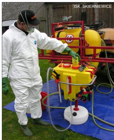
Rys. 32 Rozwadnianie preparatu przy użyciu stacjonarnego rozwadniacza współpracującego z siecią wodociągowa lub pompą opryskiwacza
