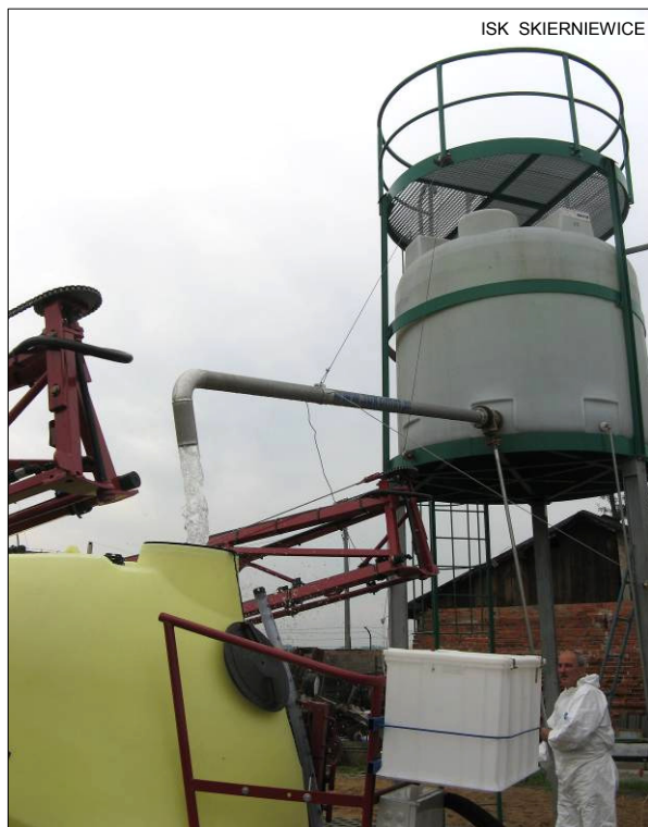
Rys. 27 Napełnianie zbiornika opryskiwacza wodą ze zbiornika pośredniego. Koniec przewodu zasilającego musi się znajdować nad krawędzią otworu wlewowego zbiornika opryskiwacza
