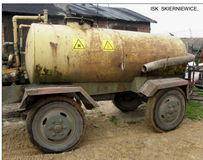
Rys.47. Zbiornik do przechowywania płynnych pozostałości - do czasu ich wykorzystania lub bezpiecznej utylizacji - musi być szczelny i wyraźnie oznaczony.
