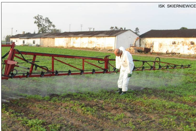
Rys. 21 Wizualna ocena jakości rozpylania podczas pomiaru wydatku rozpylaczy i przygotowania opryskiwacza do kalibracji
