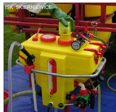
Rys. 39 Płuczka opakowań w rozwadniaczu stacjonarnym
