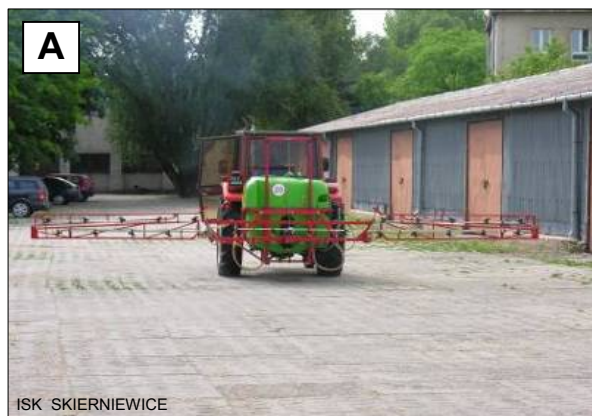
Rys. 49 Eksperyment dotyczący jednokrotnego i wielokrotnego mycia opryskiwacza z wykorzystaniem zabarwionej cieczy: A – wypryskiwanie popłuczyn podczas jazdy opryskiwacza; B - kolejny cykl płukania instalacji z poborem odpowiedniej porcji wody z dodatkowego zbiornika; C – pobieranie próbek cieczy z rozpylaczy po każdym cyklu płukania instalacji.
