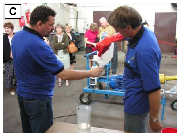
Rys. 58 Eksperyment dotyczący efektywności płukania opakowań różnymi metodami: A – płukanie ręczne jednokrotne i trzykrotne; B – płukanie przy użyciu myjki do opakowań; C – pobieranie próbek po płukaniu każdą z metod do oceny klarowności popłuczyn.
