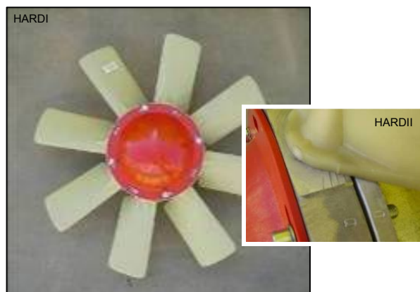
Rys. 46 Regulacja siły strumienia powietrza w opryskiwaczach sadowniczych za pomocą zmiany przełożenia w układzie napędowym (przekładnia 2-biegowa) oraz zmiany kąta ustawienia łopaty na wirniku wentylatora.
