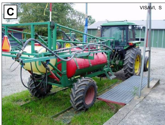
Rys. 51 Bezpieczne miejsca zewnętrznego mycia opryskiwacza: A – utwardzona powierzchnia z odpływem skażonej wody do zamkniętego zbiornika; B – rozkładane stanowisko umożliwiające zbieranie skażonej wody; C – stanowisko biobed
