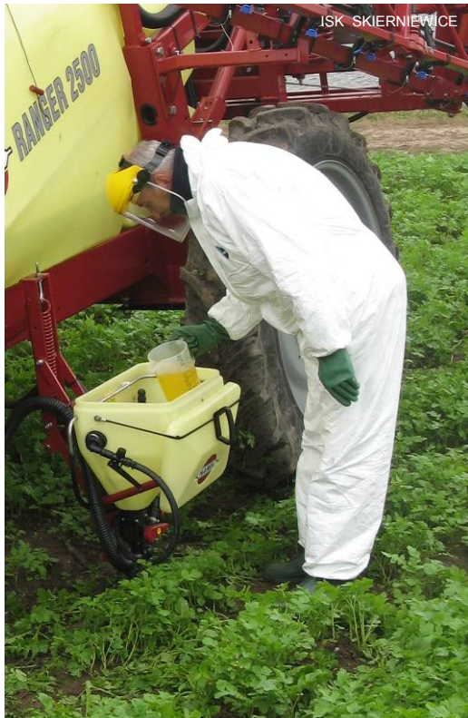
Rys. 35 Rozwadnianie środków ochrony roślin na polu przy użyciu rozwadniacza preparatów
