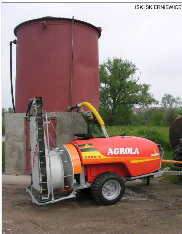
Rys. 27 Napełnianie zbiornika opryskiwacza wodą ze zbiornika pośredniego. Koniec przewodu zasilającego musi się znajdować nad krawędzią otworu wlewowego zbiornika opryskiwacza
