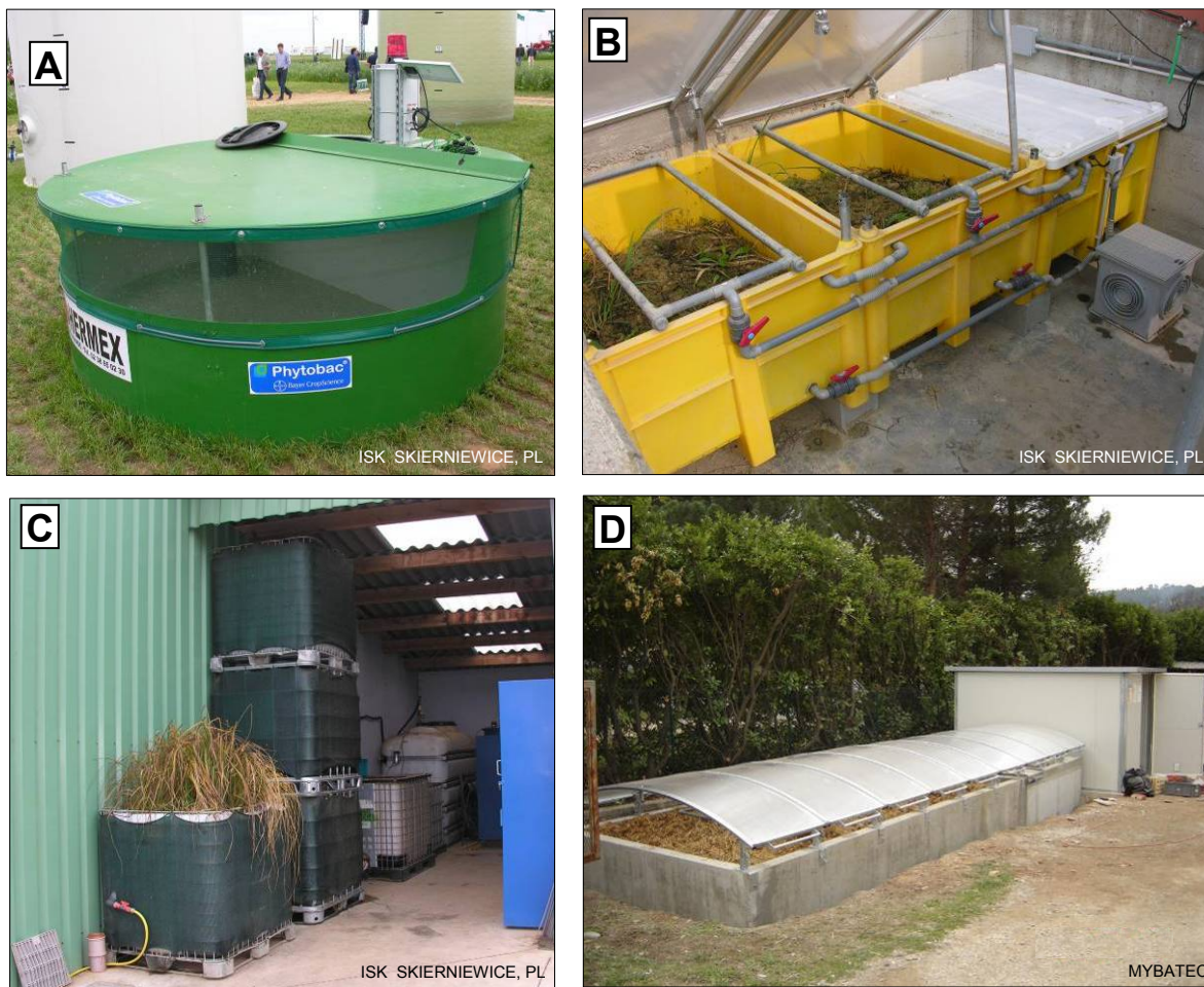
Rys.48. Urządzenia do bioremediacji pozostałości płynnych, skażonych środkami ochrony roślin: A - Phytobac; B – Mybatec; C – biofilter; D - biobac
