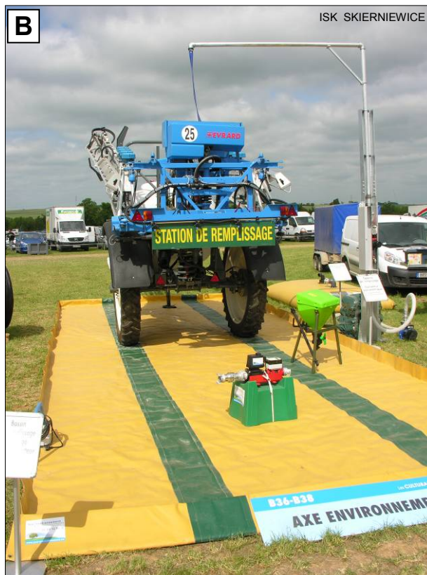
Rys. 51 Bezpieczne miejsca zewnętrznego mycia opryskiwacza: A – utwardzona powierzchnia z odpływem skażonej wody do zamkniętego zbiornika; B – rozkładane stanowisko umożliwiające zbieranie skażonej wody; C – stanowisko biobed
