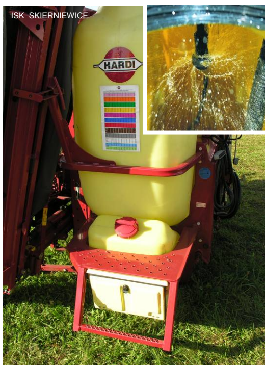
Rys. 52 Dodatkowy zbiornik na wodę do płukania instalacji cieczonej opryskiwacza oraz zraszacz do płukania zbiornika
