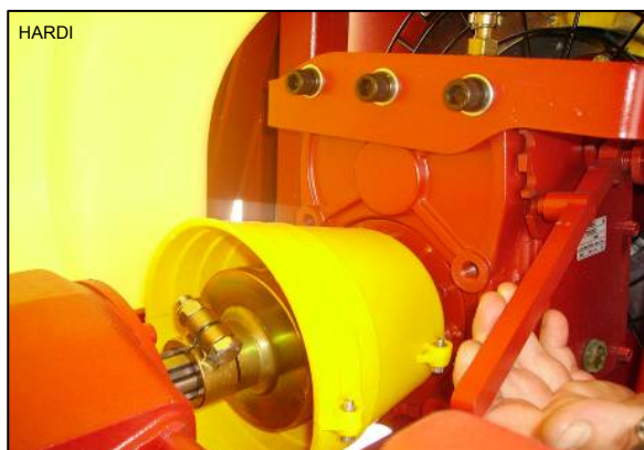
Rys. 46 Regulacja siły strumienia powietrza w opryskiwaczach sadowniczych za pomocą zmiany przełożenia w układzie napędowym (przekładnia 2-biegowa) oraz zmiany kąta ustawienia łopaty na wirniku wentylatora.
