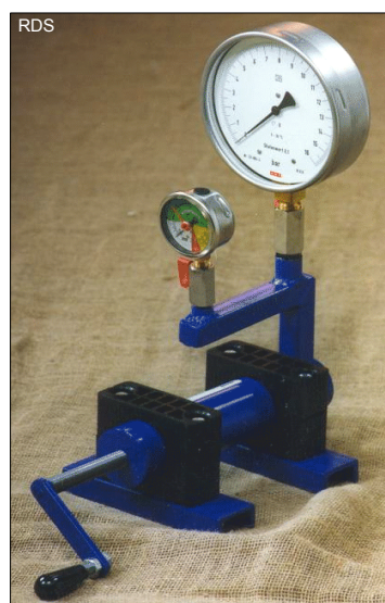
Rys. 18 Ocena prawidłowości działania manometru za pomocą praski manometrycznej z manometrem referencyjnym
