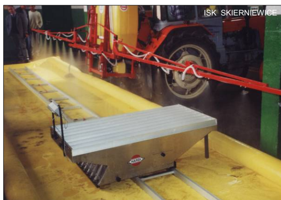
Rys. 15 Ocena rozpylaczy dla opryskiwacza polowego poprzez pomiar równomierności rozkładu cieczy na stole rowkowym
