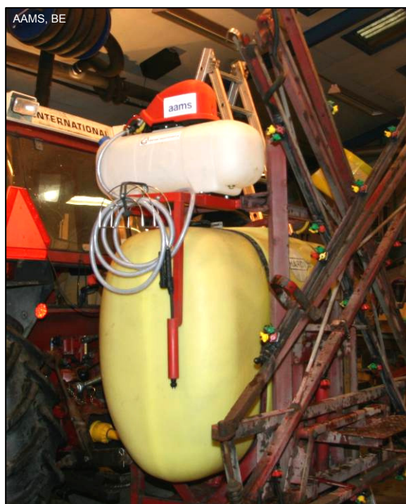
Rys. 53 Zestaw do płukania instalacji cieczonej opryskiwacza metodą ciągłą
