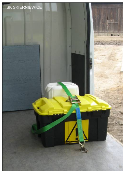
Rys. 2 Zabezpieczenie ładunku w samochodzie transportowym
