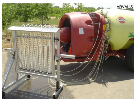
Rys. 16 Ocena rozpylaczy dla opryskiwacza sadowniczego poprzez jednoczesny pomiar wydatku cieczy
