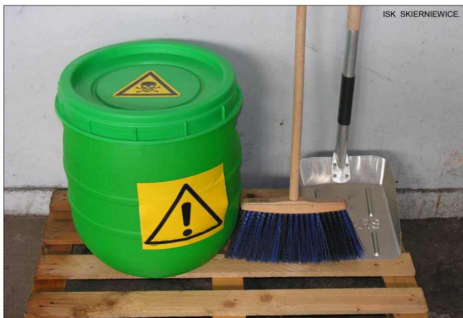
Rys. 63 Pojemnik na skażone pozostałości stałe powinien być wyraźnie oznakowany
