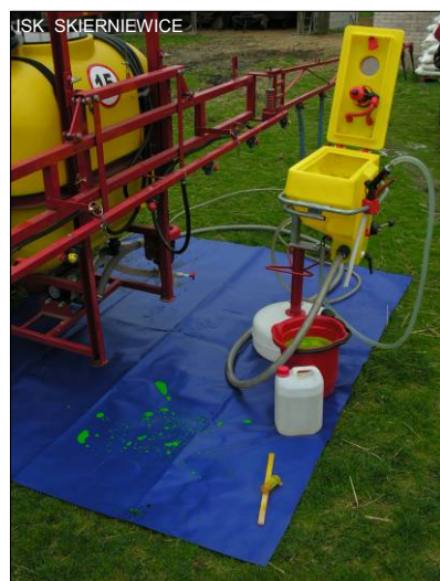
Rys. 34 Postępowanie w przypadku rozlania koncentratu środka ochrony roślin: zastosowanie materiału absorbującego (np. trociny); zebranie zwilżonego materiału do plastikowego worka i przechowanie w pojemniku na skażone pozostałości stałe (rys.11) do czasu bezpiecznej utylizacji
