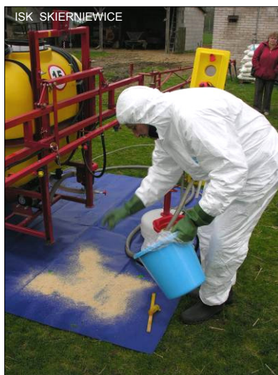
Rys. 34 Postępowanie w przypadku rozlania koncentratu środka ochrony roślin: zastosowanie materiału absorbującego (np. trociny); zebranie zwilżonego materiału do plastikowego worka i przechowanie w pojemniku na skażone pozostałości stałe (rys.11) do czasu bezpiecznej utylizacji
