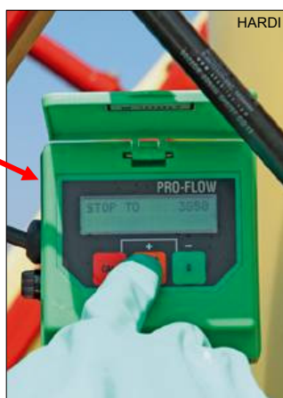
Rys. 29 Napełnianie zbiornika opryskiwacza za pomocą automatycznego systemu poboru wody z wykorzystaniem pompy opryskiwacza, przepływomierza i sterownika elektronicznego
