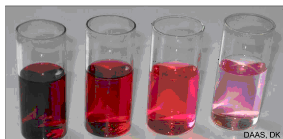
Rys. 50 próbki pobrane podczas eksperymentu z trzykrotnym pukaniem instalacji. Od lewej - ciecz pozostała po zabiegu oraz ciekłe pozostałości po kolejnych cyklach płukania.
