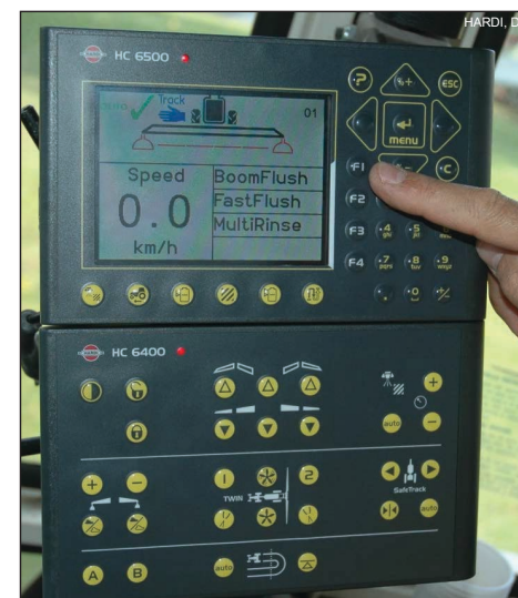
Rys. 36 Komputer pokładowy monitoruje przebieg opryskiwania oraz steruje parametrami pracy opryskiwacza w celu precyzyjnej realizacji założonej dawki cieczy
