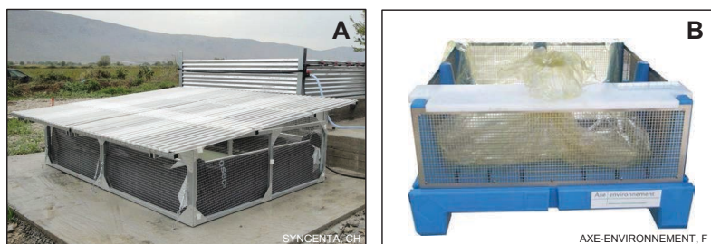
Rys. 44 Stanowiska dehydratacyjne: A – HELIOSEC, B – OSMOFILM
