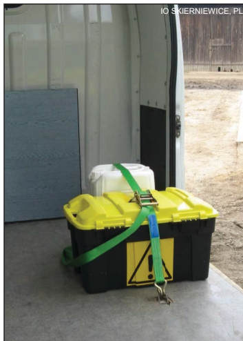
Rys. 1 Niewielkie ilości środków ochrony roślin należy przewozić w szczelnym i zabezpieczonym pojemniku
