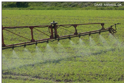
Rys. 18 Zastosowanie rozpylaczy płaskostrumieniowych 110^{\circ} - 120^{\circ} i prowadzenie belki polowej na wysokości 35-50 cm pozwala na uzyskanie równomiernego rozkładu cieczy na opryskiwanej powierzchni
