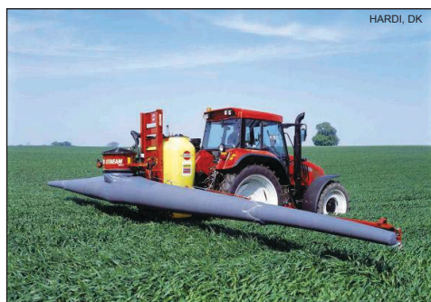
Rys. 24 Opryskiwacz polowy z pomocniczym strumieniem powietrza (PSP)
