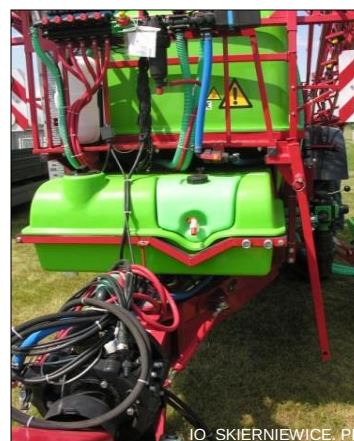
Rys. 28 Dodatkowy zbiornik na wodę do mycia instalacji cieczowej
