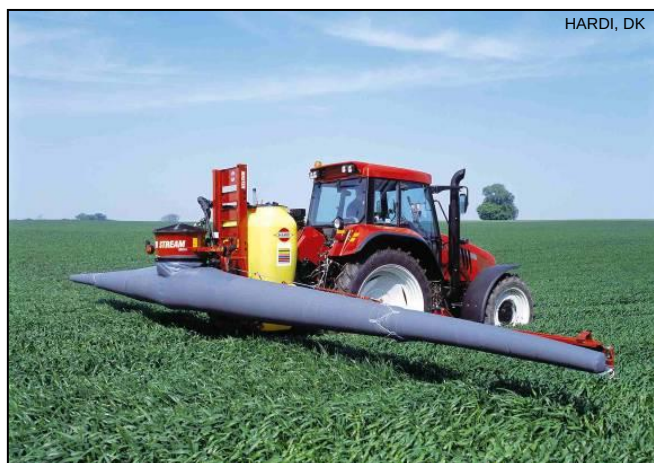
Rys. 24 Opryskiwacz polowy z pomocniczym strumieniem powietrza (PSP)
